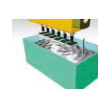
焊錫槽的液面高度檢查
