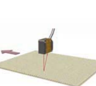
瓦楞紙中間凹凸部分之高度檢查
