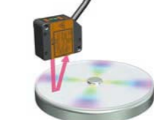
磁碟馬達平台的表面震動
