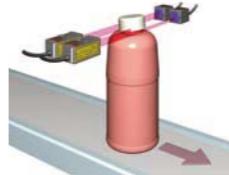
間隙翹起的檢測
