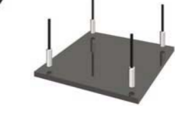
鋼板面積檢查
